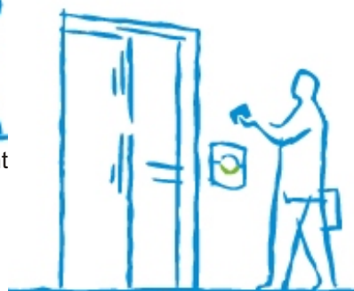
Distanza di lettura fino a 4 cm con il sistema di accessi standard
