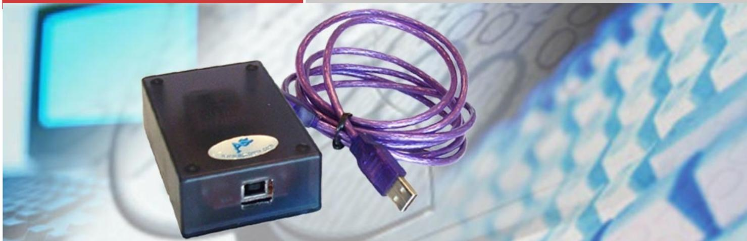
Controller che permette la gestione (lettura e scrittura) dei principali transponder a tecnologia 125 kHz. Integra il modulo A&12501 dotandolo, grazie all'utilizzo della scheda A&6912.U, di interfaccia USB, di antenna dalle dimensioni contenute e di led diagnostici.
