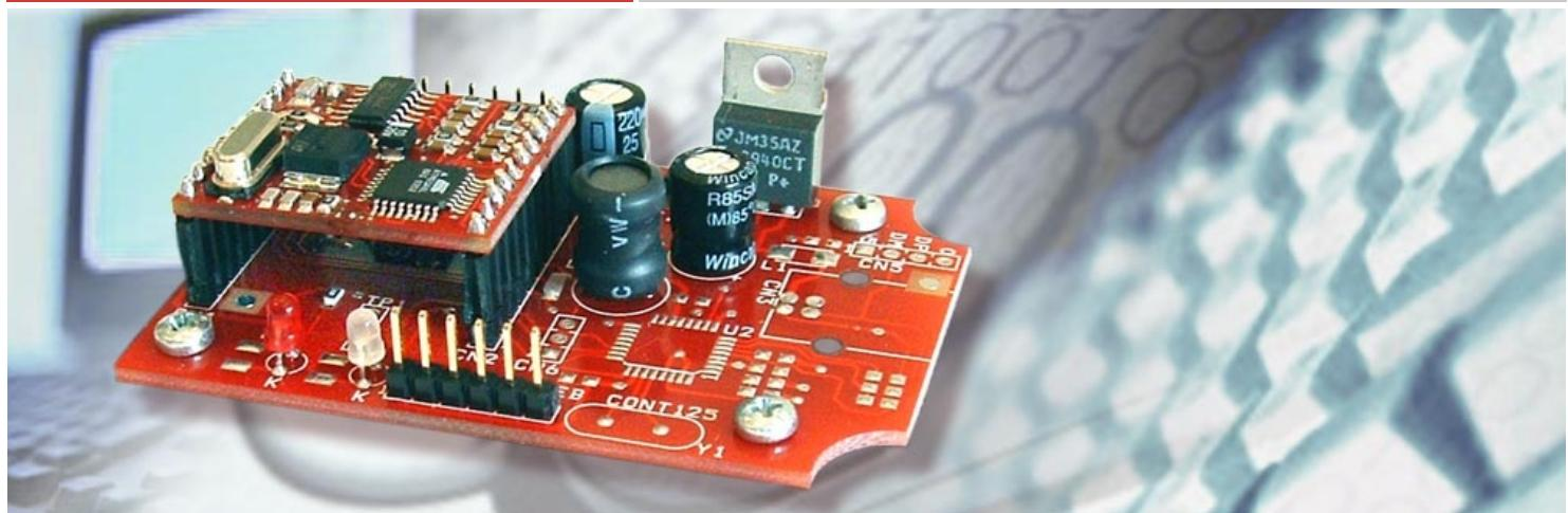
Si tratta di un controller che permette la gestione (lettura e scrittura) dei principali transponder a tecnologia 125 kHz. Integra il modulo A&12501 dotandolo, grazie all'utilizzo della scheda A&6912.A, di interfaccia standard RS232, di antenna dalle dimensioni contenute e di led diagnostici. Ideale per applicazioni come vidimatore o programmatore di tag. In questa versione è fornito senza contenitore, come sola PCB.
